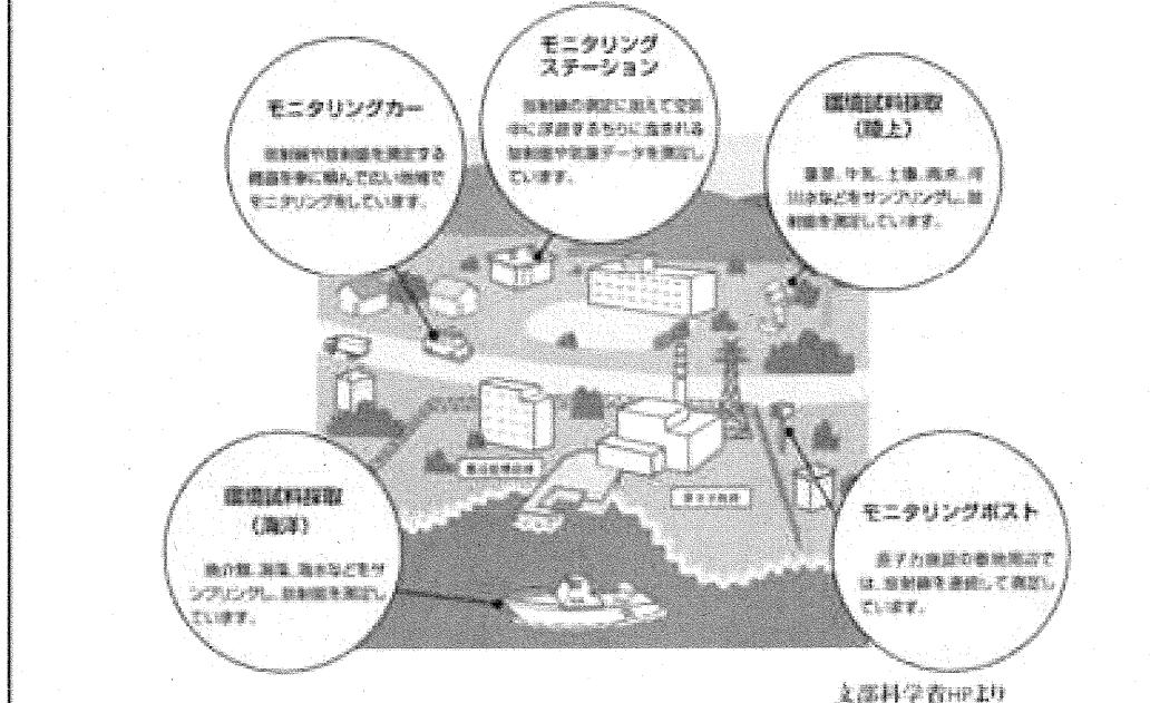
平常時の環境放射線モニタリングの概念図です。平常時モニタリングは地方公共団体が原子力事業者と共に実施することが求められています。モニタリングポストは空間線量率を連続的にモニタできる野外測定設備で、各都道府県の県庁所在地などに1台ずつ置かれています。福島第一原発の事故以降、設置台数も増えています。更に、空気中の放射性物質の濃度測定の機能を備えた施設がモニタリングステーションです。モニタリングカーを用いた移動サーベイも環境放射線モニタリングに有効です。こういった測定は主に県が中心となって実施しています。
